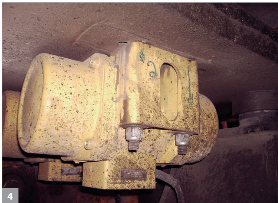
Gerichtete vertikale Schwingung durch zwei Außenrüttler vom Typ Bosch 18120
