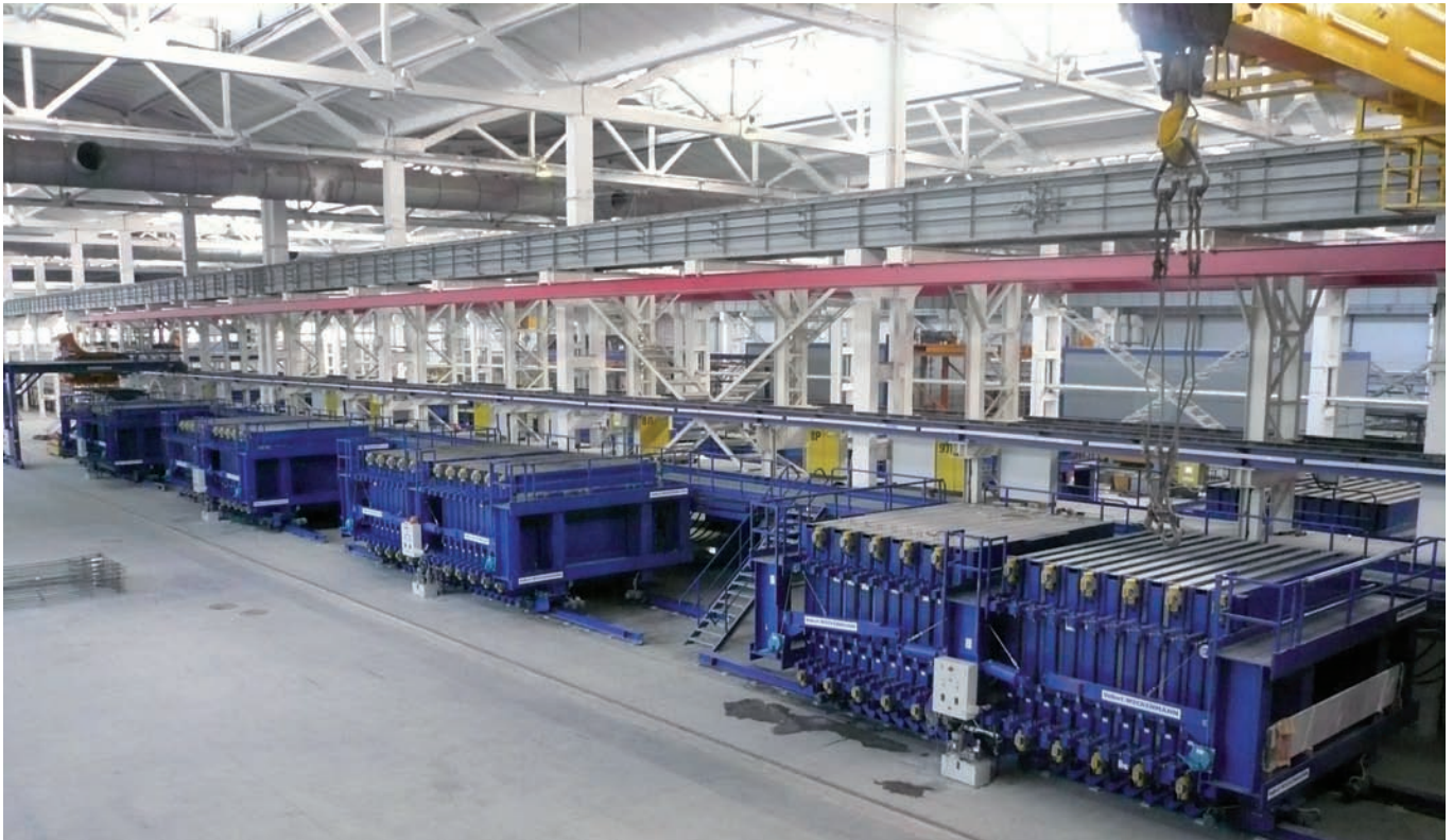
Abb. 2: Eine zweite Reihe von vier Batterieschalungen verläuft parallel zur ersten Reihe. Die Steuerungstechnik der Vibration ist „back to back“ installiert und funktionsgleich. Die Funksteuerungen sind jedoch gegeneinander verriegelt.
