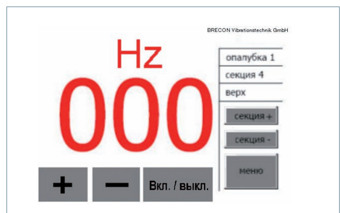
Abb. 7: TouchPanel: Die angezeigte Vibrationsfrequenz kann jederzeit am TouchPanel oder per Funksender angepasst werden. Daneben zur Kontrolle Informationen über den Betonierort.
