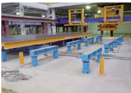
Abb. 9: Synchronrüttler in der Vibrationsstation
