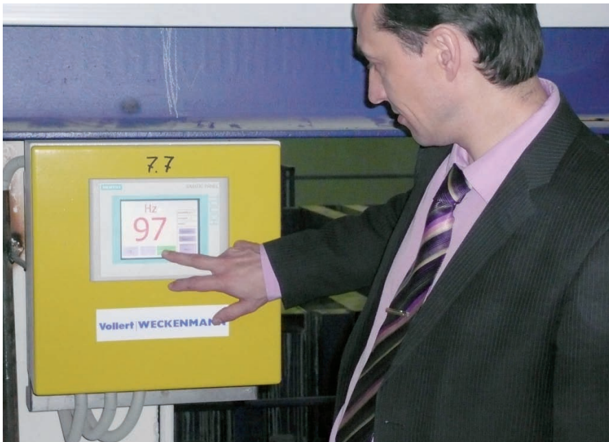
Abb. 8: Projektleiter Alexander D. Jaroschenko (DSK Blok) bedient die Vibrationsverdichtung über eines der neun Brecon Touch Panels.
