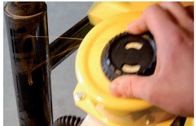
Abb. 4: Die Resonanzschwingung zeigt die momentane Frequenz an
