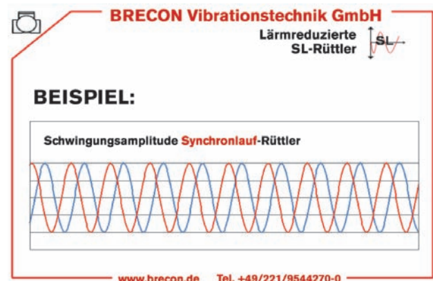
Abb 5: Nur bei SL-Rüttler sind mechanische und elektrische Frequenz absolut identisch, die exakte Drehzahl lässt sich deshalb am Frequenzumrichter ablesen
