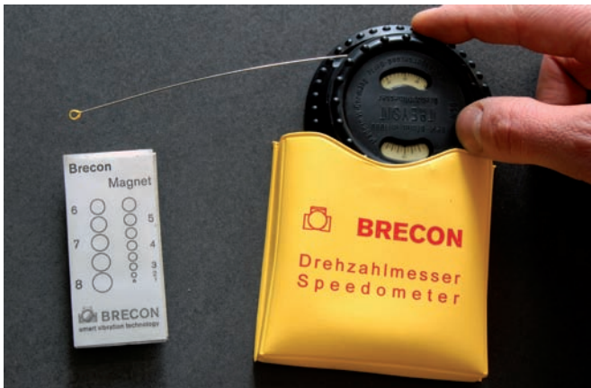
Abb. 3: Das Hilfsgerät zur Frequenzermittlung im Ruhezustand
