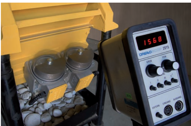
Abb. 1: Genaue Messung von Frequenz, Amplitude und Synchronität erfordert teure Messgeräte
