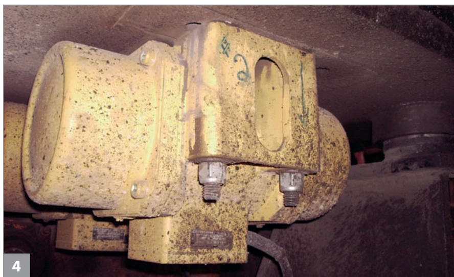
4 Oscilaciones dirigidas verticalmente a través de dos vibradores exteriores del tipo Bosch 18120
