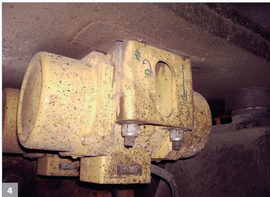
Vibration verticale par deux vibrateurs externes de type Bosch 18120
