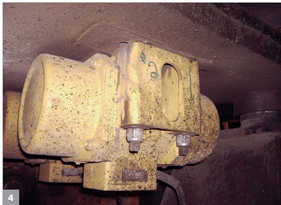
4 Oscillazione verticale da parte di due vibratori esterni modello Bosch 18120
