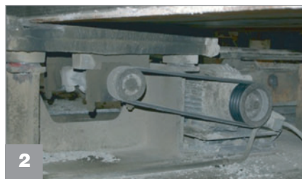
Старый модуль для уплотнения бетона с клиноремённой передачей.
