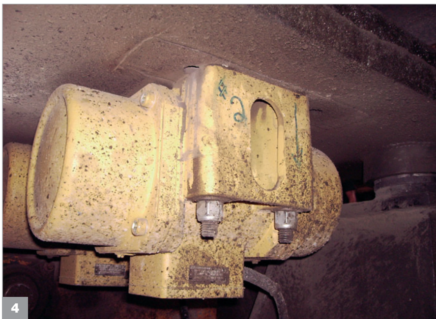
4 Вертикальная вибрация, создаваемая двумя поверхностными вибраторами Bosch 18120.
