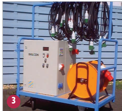
3 Le consommateur définit les détails tels que cadre de protection périphérique, prise monophasée et ligne d'alimentation sur bobine de câble
