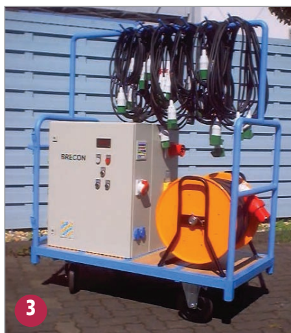
3 L'utente finale collabora a determinare dettagli come il telaio protettivo perimetrale, la presa elettrica monofase supplementare e la linea di alimentazione sul tamburo per cavi
