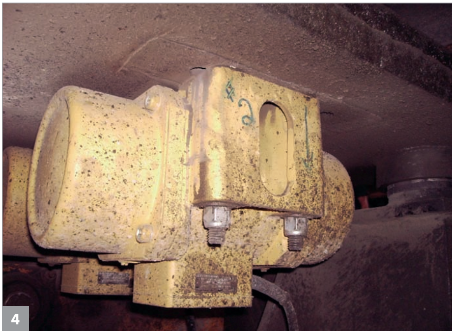
4 Gerichtete vertikale Schwingung durch zwei Außenrüttler vom Typ Bosch 18120
