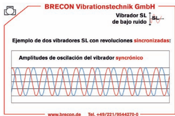
Fig. 5: solo en el caso de los vibradores SL las frecuencias mecánica y eléctrica son idénticas y el número exacto de revoluciones puede leerse por ello en el convertidor de frecuencia
