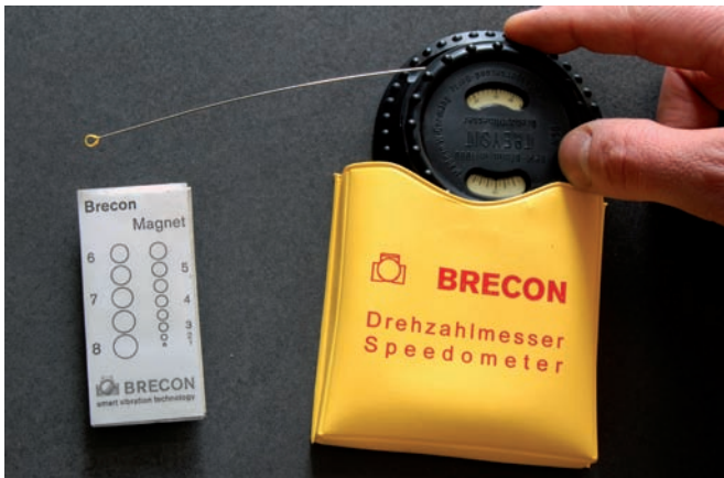
Fig. 3: L'appareil auxiliaire servant à déterminer la fréquence au repos
