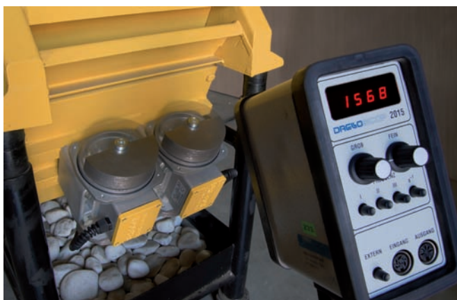
Fig. 1: Le mesurage précis de la fréquence, de l'amplitude et du synchronisme demande d'utiliser des appareils de mesure coûteux
