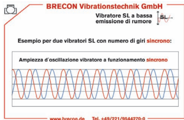
Fig. 5: Solo nei vibratori SL la frequenza meccanica e quella elettrica sono assolutamente identiche e il regime esatto può essere quindi letto sul convertitore di frequenza
