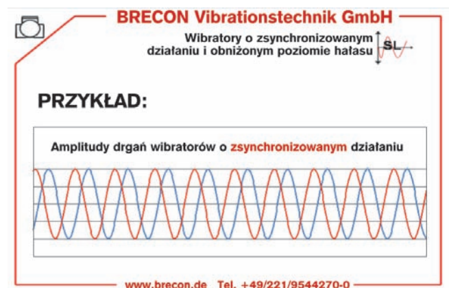
5: Tylko w przypadku wibratorów o zsynchronizowanym działaniu częstotliwość prądu i częstotliwość drgań mechanicznych są sobie równe, a dokładną prędkość obrotową można odczytać na przetwornicy częstotliwości.
