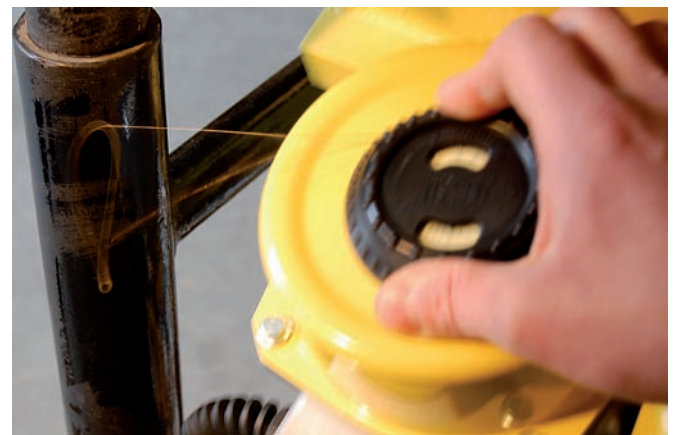
4: Drgania rezonansowe wskazują chwilową wartość częstotliwości.
