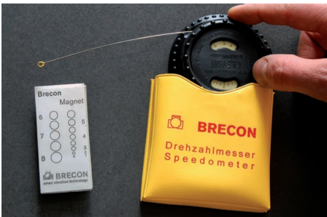
3: Przyrząd pomocniczy do określania częstotliwości, w stanie spoczynku.
