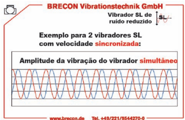
Fig. 5: Somente os vibradores SL apresentam frequência mecânica elétrica absolutamente idêntica, razão pela qual é possível verificar o número exato de rotações no conversor eletrônico de frequência
