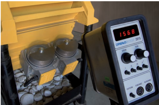
Fig. 1: A medição exata da frequência, amplitude e sincronicidade requer equipamentos de medição caros
