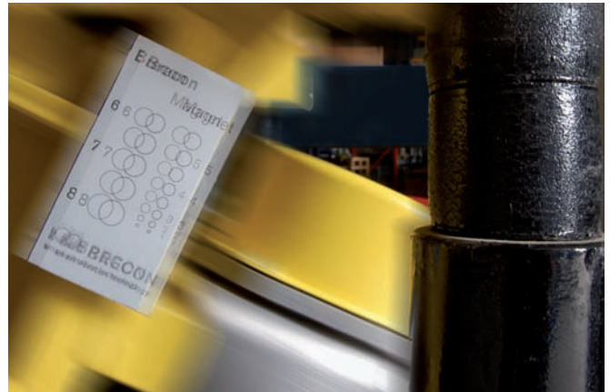
Fig. 2: A amplitude pode ser determinada rapidamente com o ímã Brecon
