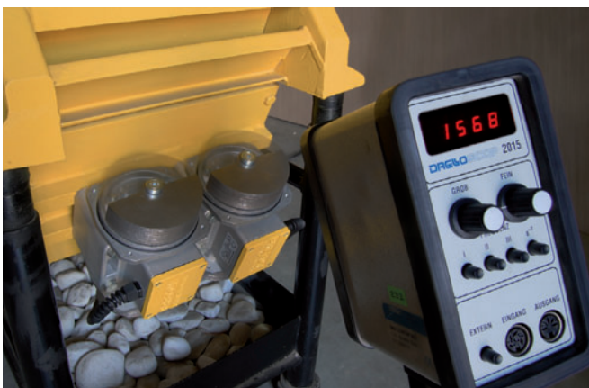
Рис. 1: Точное измерение частоты, амплитуды и синхронности требует дорогостоящих измерительных инструментов
