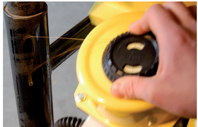
Рис. 4: Резонансные колебания показывают частоту колебаний
