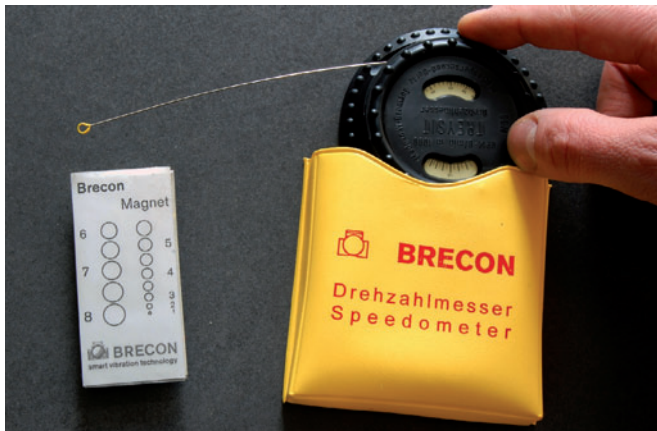
Рис. 3: Устройство для измерения частоты в состоянии покоя
