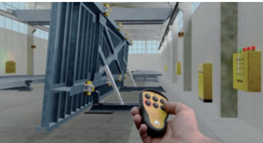
Abb. 1: Eine neue Serie von betonwerkstauglichen Funksendern macht die Bedienung ortsunabhängig.
