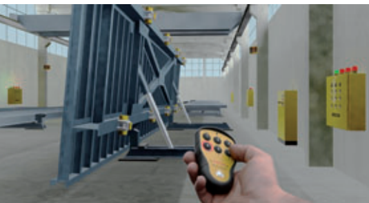
Fig. 1: une nouvelle série de radioémetteurs compatibles avec l'environnement d'une fabrique de béton permet une commande de tout endroit du site.
