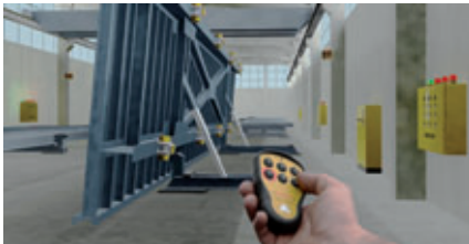
Fig. 1: Una nuova serie di radiotrasmittitori adatti agli stabilimenti di produzione del calcestruzzo rende le operazioni di comando indipendenti dal luogo in cui vengono applicate.
