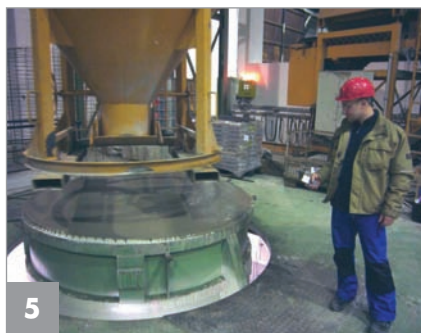
Kontrolle des Verdichtungsprozesses über Handfunk
