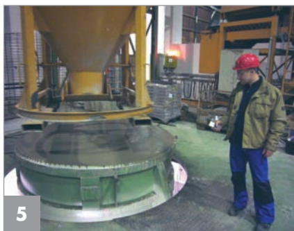
Control del proceso de compactación por control remoto
