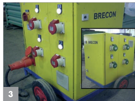
Sistema de control móvil para los vibradores SL (rojos) y los vibradores convencionales (verdes)
