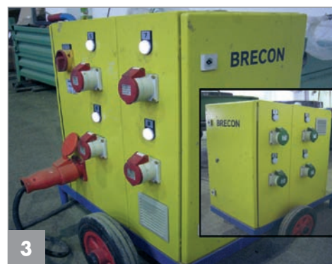
Système de commande mobile pour vibreurs asynchrones (rouges) et vibreurs conventionnels (verts)
