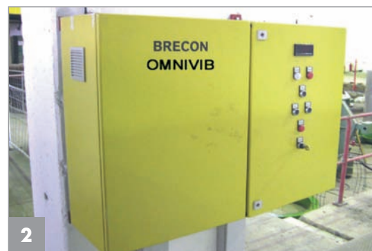
Controllo centrale del sistema Omnivib installato in modo fisso
