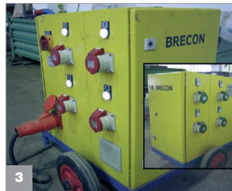
Передвижная аппаратура управления вибраторами SL (красный цвет) и традиционными вибраторами (зелёный цвет)
