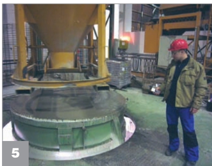
Контроль над процессом уплотнения с помощью ручного пульта радиоуправления
