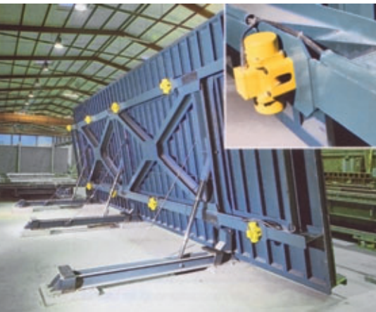
Abb.1: Beispiel für eine vorbildliche Rüttlermontage
