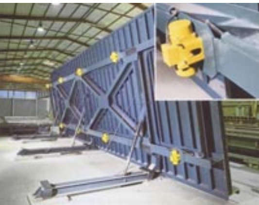
1: Przykład wzorowego zamontowania wibratorów przyczepnych.
