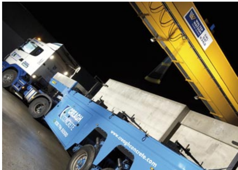
Załadunek prefabrykowanych płyt ściennych na specjalną naczepę w Toomebridge.
