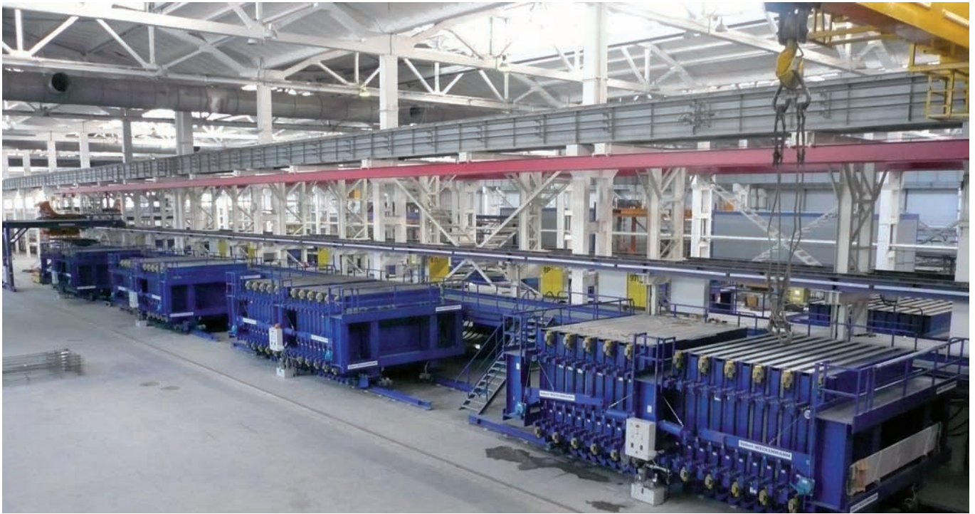
Fig. 2: Una segunda fila de cuatro encofrados en batería se extiende paralela a la primera fila. La técnica de control de la vibración está instalada "back to back" y es de funciones similares. Los radiocontroles sin embargo están enclavados entre sí.
