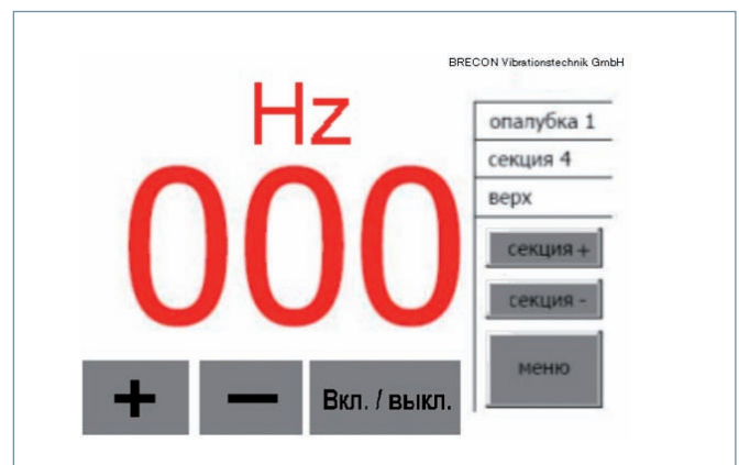
Fig. 7: Panel táctil: La frecuencia de vibración indicada puede ser adaptada en todo momento en el panel táctil o por transmisor de radiofrecuencia. A un lado para control, informaciones sobre el lugar de hormigonado.
