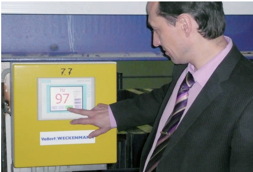
Fig. 8: Le chef de projet Alexandre D. Jaroschenko (DSK Blok) commande le compactage par vibration via l'un des neuf écrans tactiles de Brecon.
