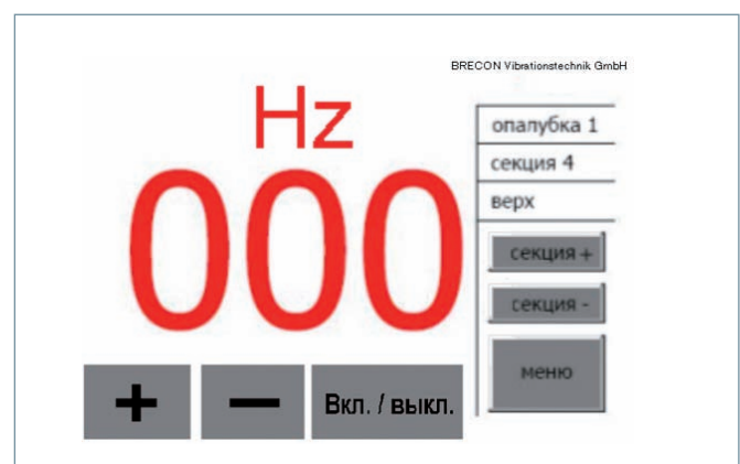
Fig. 7: Écran tactile o : La fréquence de vibration affichée peut être adaptée à tout moment par l'écran tactile ou par émetteur radio. En parallèle pour le contrôle, des informations sur le lieu de bétonnage.
