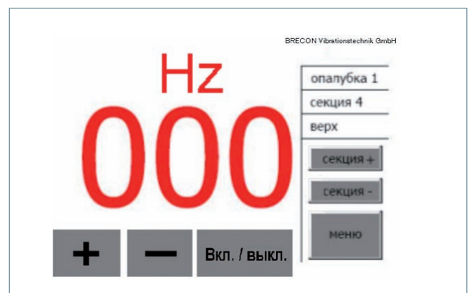
Fig. 7: Touch panel: La frequenza di vibrazione visualizzata può essere modificata in qualsiasi momento da touch panel o tramite il radiotrasmettitore. Vicino al controllo, informazioni sul punto di betonaggio.
