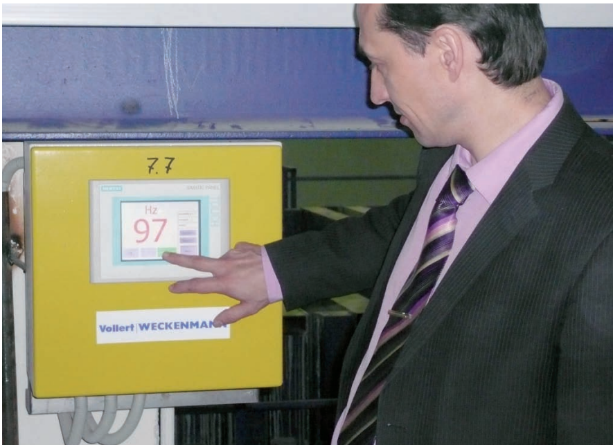
Fig. 8: Il responsabile di progetto Alexander D. Jaroschenko (DSK Blok) comanda la compattazione mediante vibrazione da uno dei nove touch panel Brecon.
