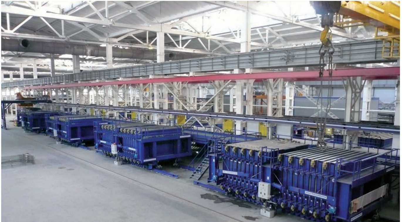
Fig. 2: Una seconda fila di casseforme in serie è disposta parallelamente alla prima fila. Il sistema di controllo della vibrazione è installato "back to back" e svolge le stesse funzioni. I radiocomandi sono bloccati reciprocamente.
